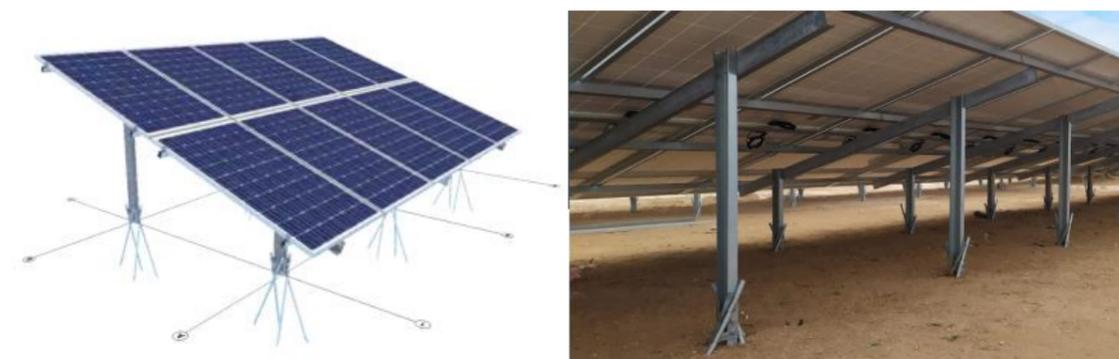
Figure 2 - Exemple de structure avec fixation micropieux<sup>7</sup>
