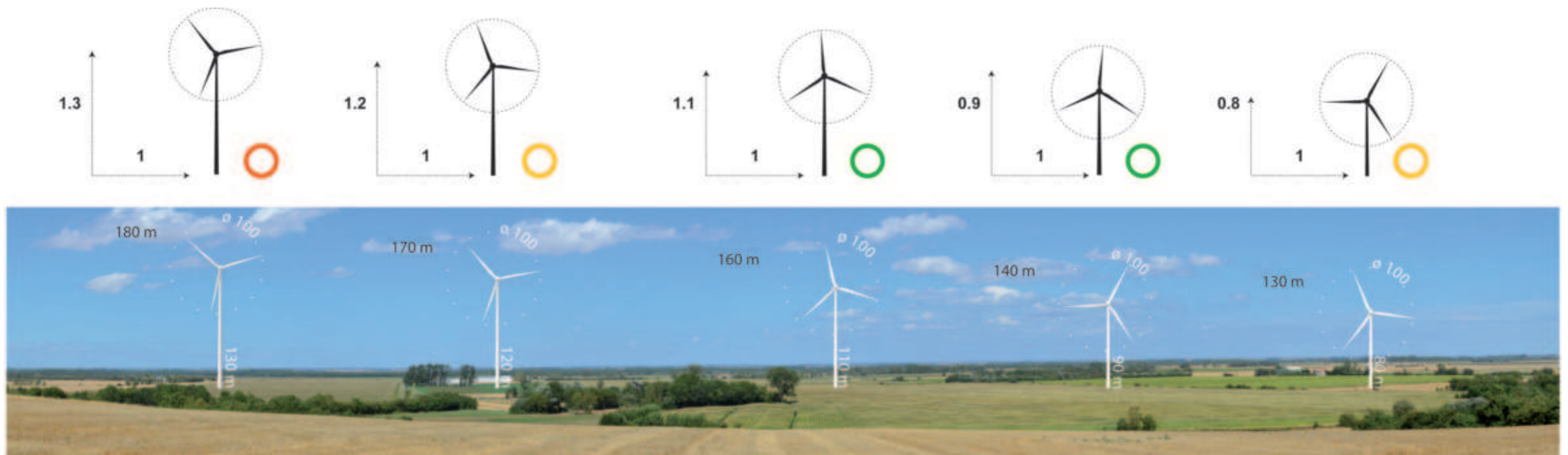
Figure 25 : Exemple du rapport de proportion entre le diamètre du rotor et la hauteur de mât.
