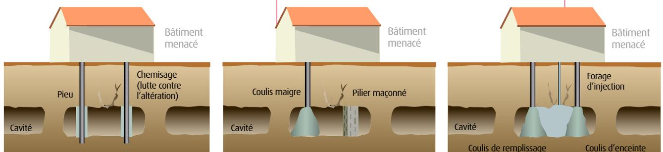
Lorsqu'une cavité souterraine est repérée sous un bâtiment existant ou projeté, on peut soit combler la cavité, si elle est petite, soit implanter des fondations profondes si elle est trop grande.
