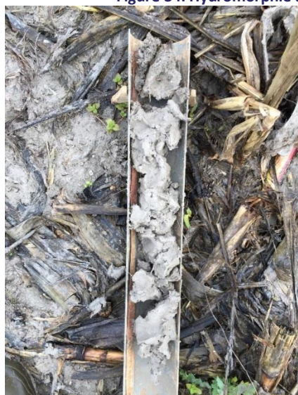
Figure 34. Hydromorphie au point de sondage du VERTISOL carbonaté anthropisé cultivé profond
