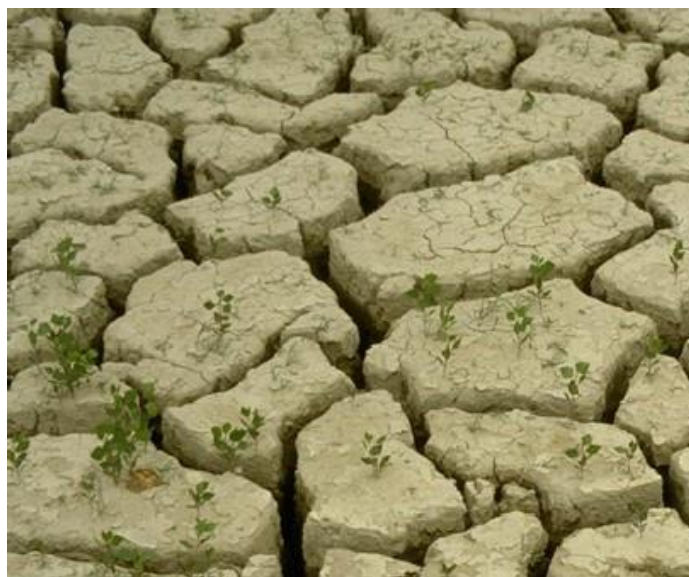
Figure 32. Phénomène de rétraction de l'argile
