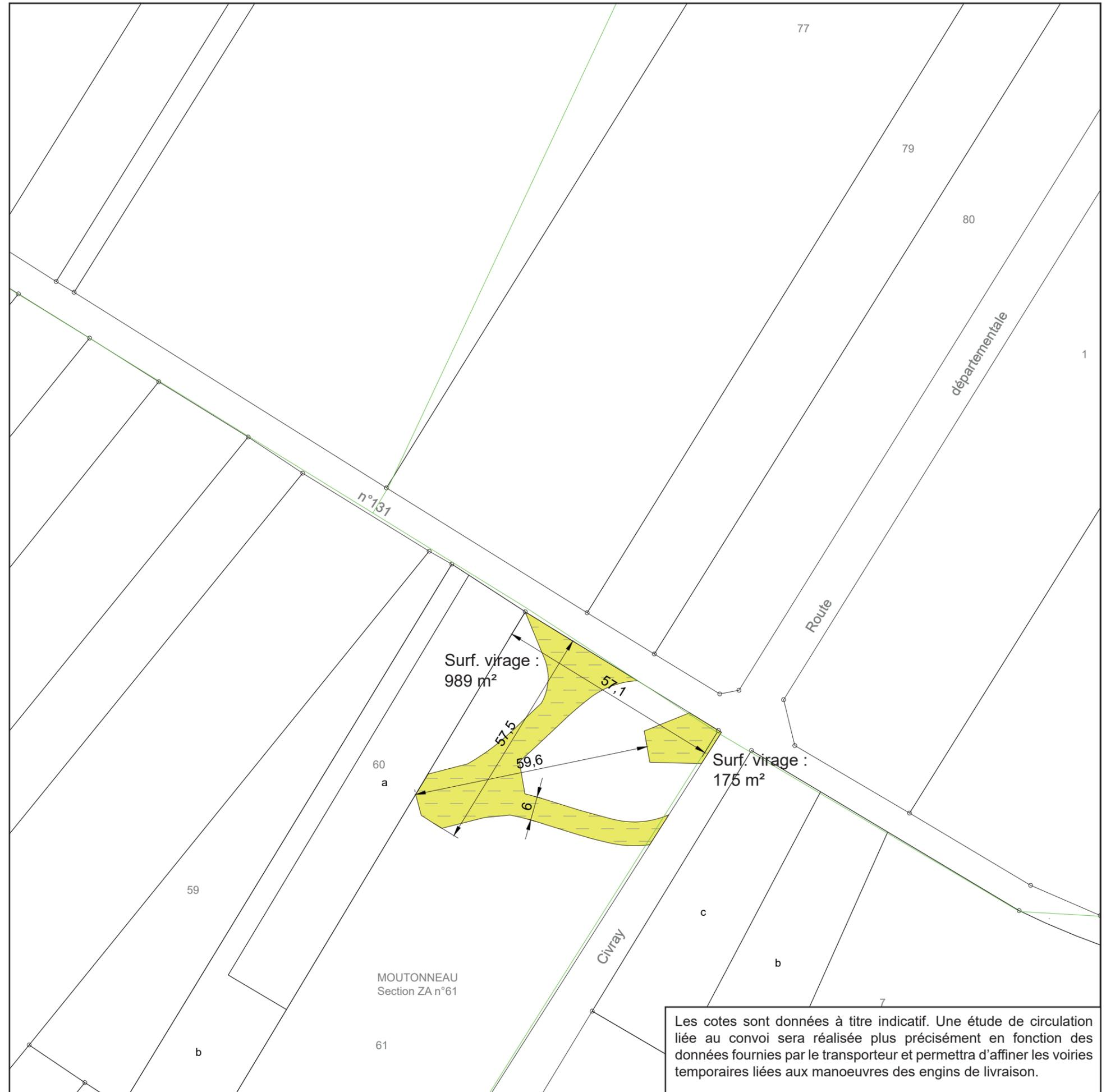
Les cotes sont données à titre indicatif. Une étude de circulation liée au convoi sera réalisée plus précisément en fonction des données fournies par le transporteur et permettra d'affiner les voiries temporaires liées aux manoeuvres des engins de livraison.
