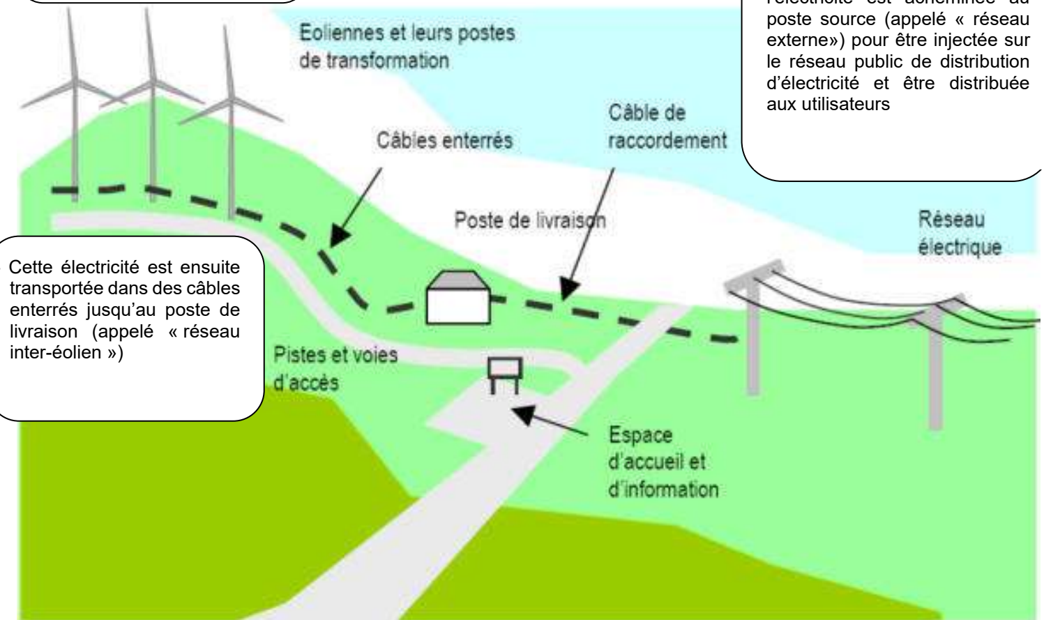
Illustration 1 : Schéma descriptif d'un parc éolien terrestre (rapports d'échelle non représentatifs) (source : Guide de l'étude d'impact sur l'environnement des parcs éoliens, actualisation 2010)
