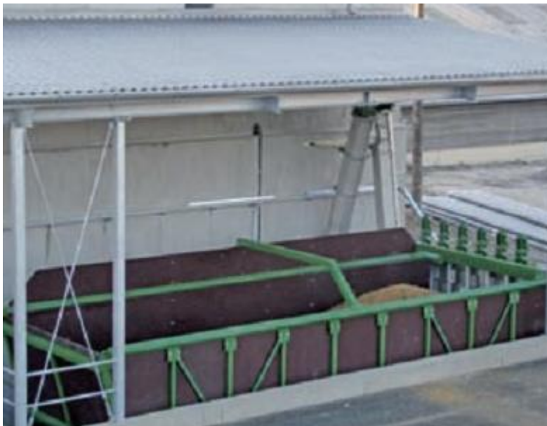
Figure 15 : Technologie d'incorporation des matières solides (Source : Biogest)
