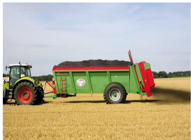
Figure 65 : Épandeur à table d'épandage (Crédit photo : NCA, 2012)
