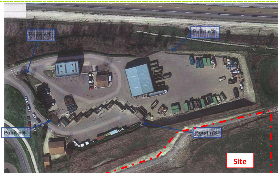
Figure 35 : Localisation des points de mesures sonométriques
