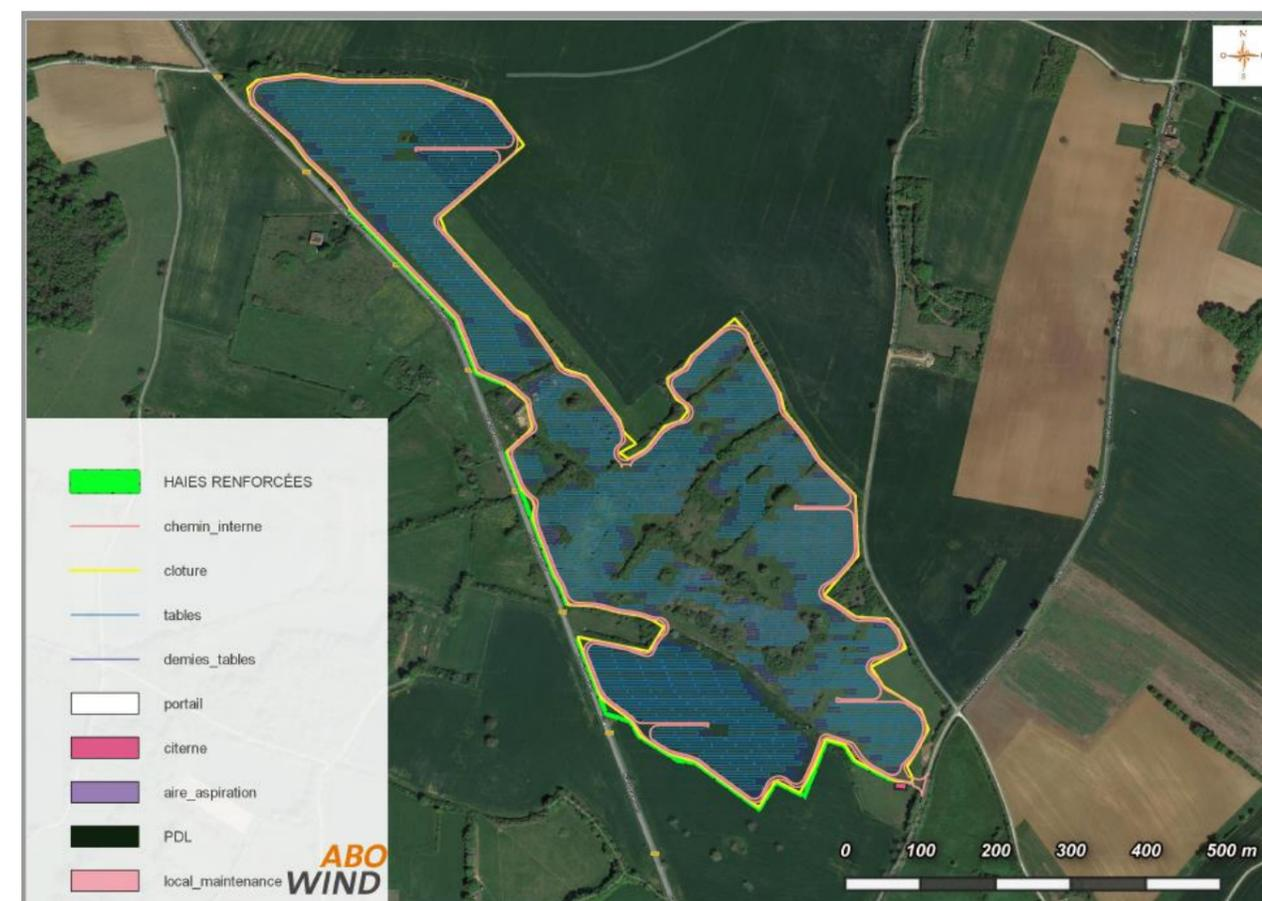
Figure 30 : Présentation de la variante 2 du projet de centrale photovoltaïque au sol de Chasseneuil-sur-Bonnieure
