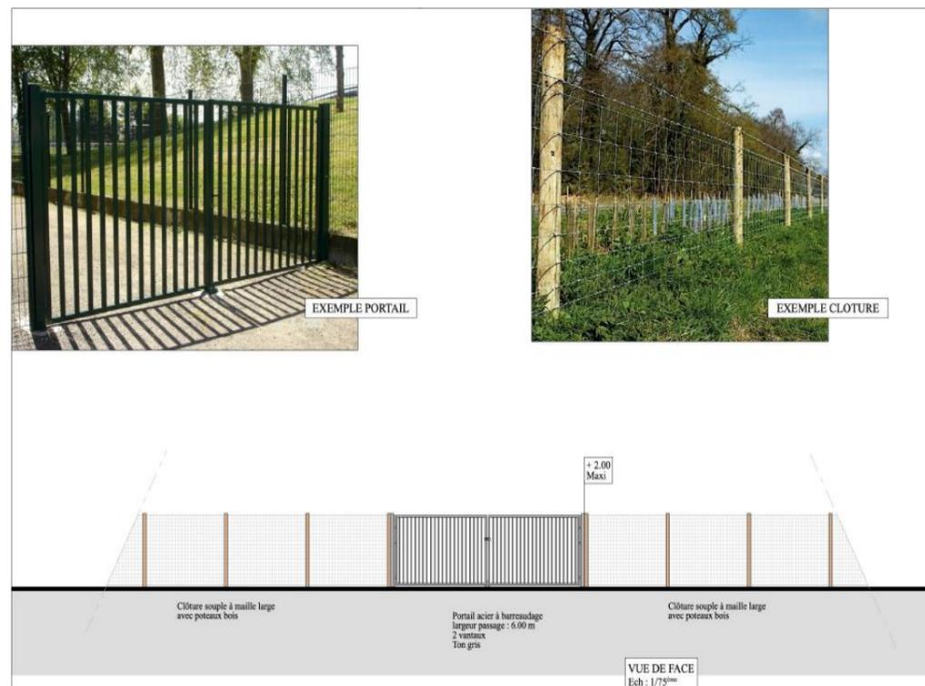
Figure 22 : Exemple de clôture et de portail
